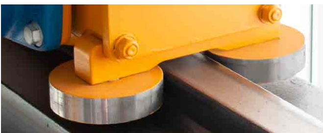
Geleidingrollen bij de bovenste kraanbaan
