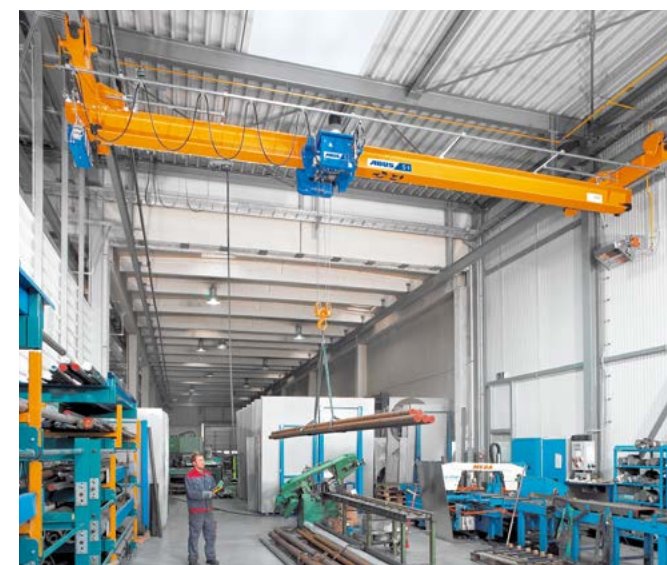
Kortgebouwde loopkat type E aan een onderhangende loopkraan EDL.
