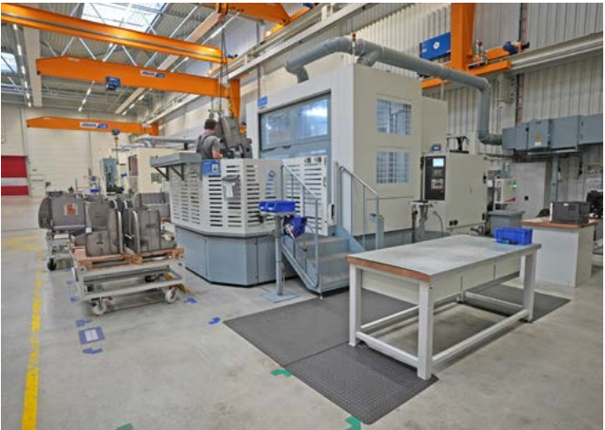
Mechanische bewerking van het staaldraadtakelframe op 4-assige freescentra
